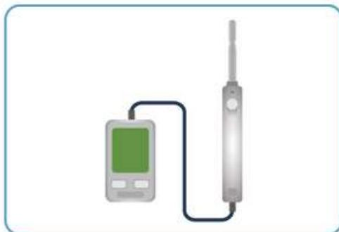
例えば製薬工場や病院など、無線の電波使用に制限のある場所では、一般的な風速計と同様にケーブルを用いた計測が可能です。
