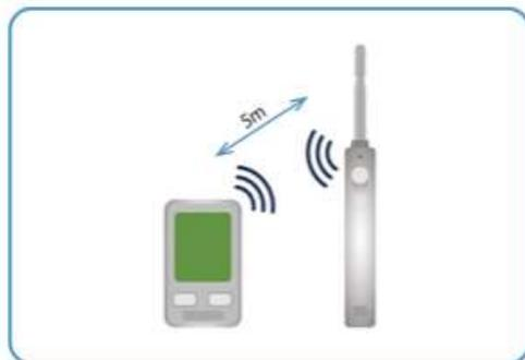
無線通信の届く範囲(5m)なら、高い場所などプローブを離しての計測が可能です。計測者と記録者がプローブと表示ユニットを各々持って計測するといった使い方もできます。ダクト点検口にプローブを挿入する際、ケーブルを引っかけて破損する心配もありません。
