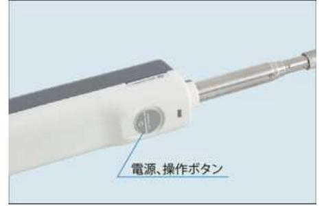
計測値のホールドや計測の開始/停止などの基本操作を行うことができます。また、LEDランプで通信状態やバッテリー残量などを確認することができます。
