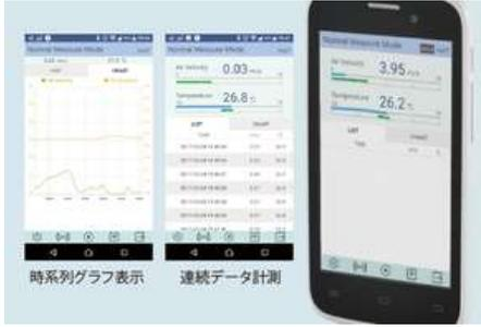
計測ソフトウェアでは、通常の計測値表示に加えて、グラフ表示や連続のデータ取り込み、CSV保存を行うことができます。風速・温度個別に上下限値を設定することで、画面上にアラート表示も行えます。
