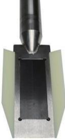
プローブに付属のプラスチック製シャベル(左図)を装着してください。プローブを挿入したときに大きな砂利が、測定中にセンサーから流れ動かないようにします。
