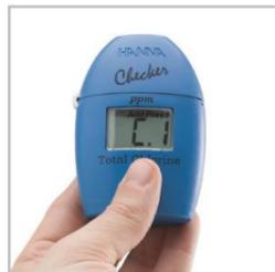
測定する水を入れたガラスセルを本体にセットし読み込みます。
