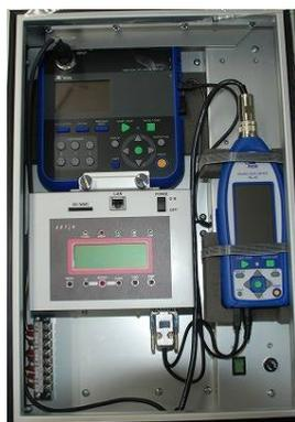
内側（裏面）に、騒音計・振動計・指示計が収納されており、指示計の操作パネルから各種設定を行うことができます。
