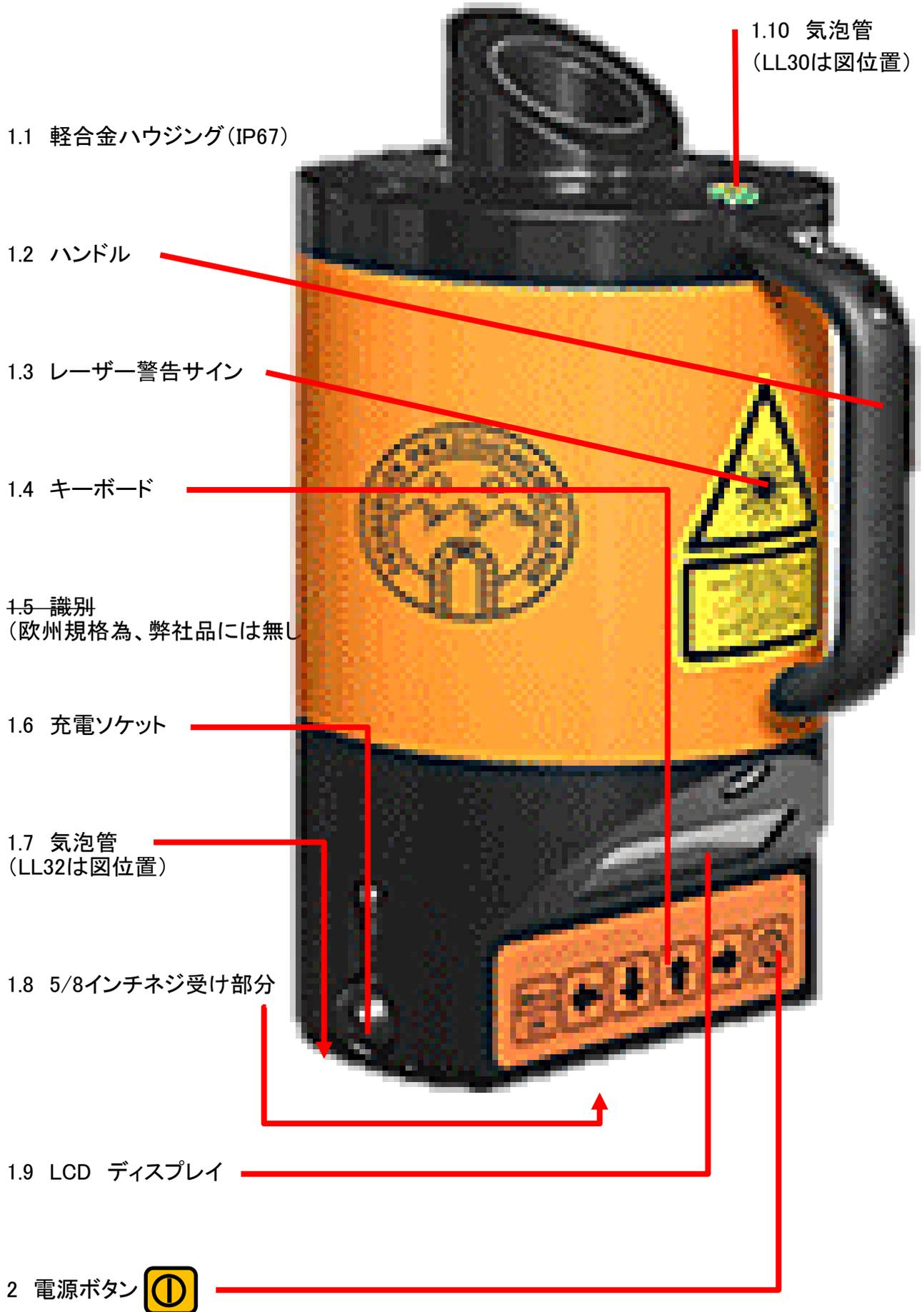
製造番号が表示され、レーザー光が点滅(自動整準中)から点灯になると水平が取れている状態となります。
