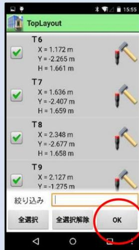
最初の杭打ち点方向にLN-100 は自動的に向いてプリズムをサーチし始めます。
