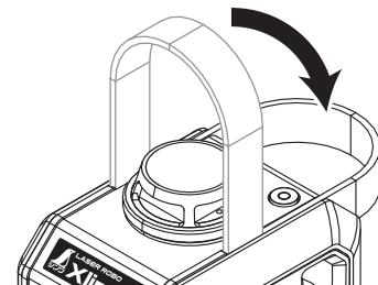
②円型気泡管の気泡が白い円内に入るよう、水平調整脚で調整し、本体の水平出しを行ってください。
