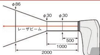
測定対象物に触れずにボタン1つで表面の温度測定ができる、非接触型の温度計です。
