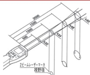
測定対象物に触れずにボタン1つで表面の温度測定ができる、非接触型の温度計です。
