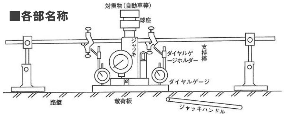
Φ 300mmの載荷板を油圧ジャッキで設置して段階的に荷重を載荷し、その時の荷重量と沈下量から構造物基礎の地耐力(支持力)を求めることが可能
