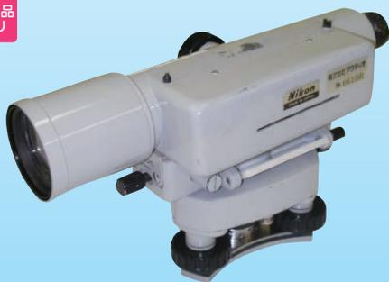
望遠鏡視野内の気泡像を合致させる事で水平状態を保つマニュアルレベルです。
