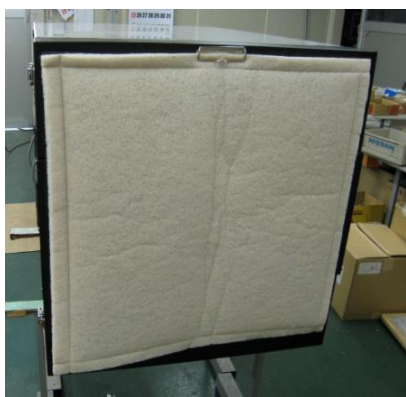
写真4 リングフィルタの取り付け完了写真
