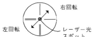
レーザー光軸調整ねじB
