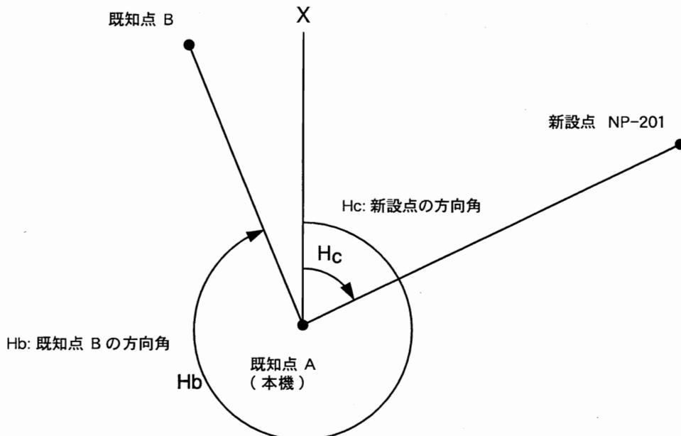
放射法を行う前に、測設メニュー 1/2において、機械点の座標および方向角を設定しておきます。
