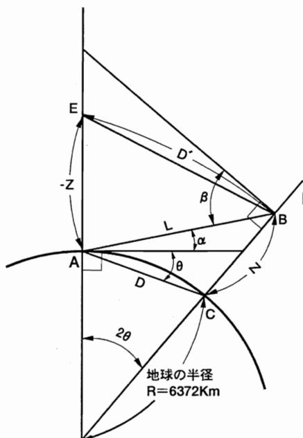
両差補正を停止したとき、水平距離、比高の換算式は、下記のようになります。
