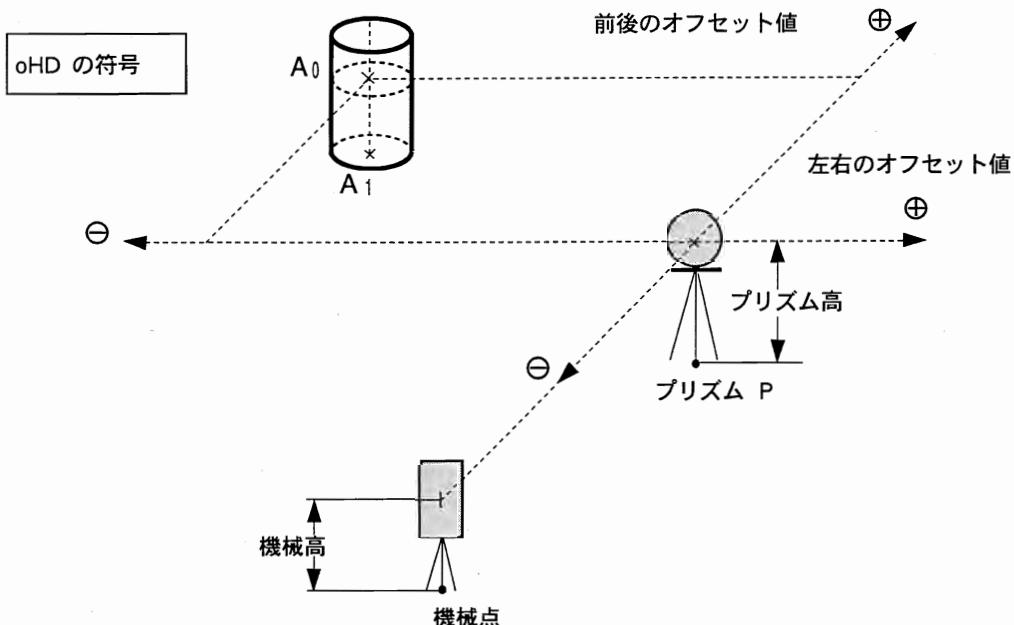
A<sub>1</sub>点（地面）を測定するとき： 機械高、プリズム高を設定します。
