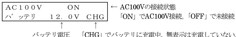
AC100Vが「OFF」の時、本機はDC12Vで動作しています。
