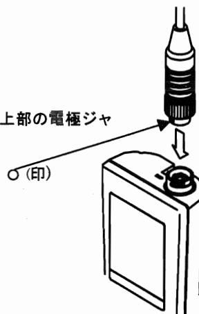
③ 固定リングのみを回し、電極プラグを固定します。
