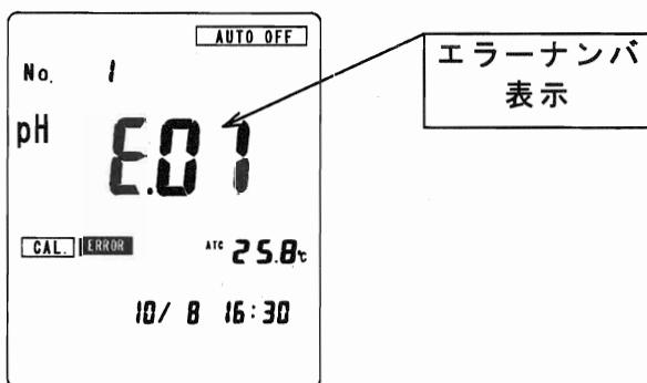
エラーナンバが表示されましたら、次ページのエラー表示一覧表を参照の上、適切な処置を行って下さい。
