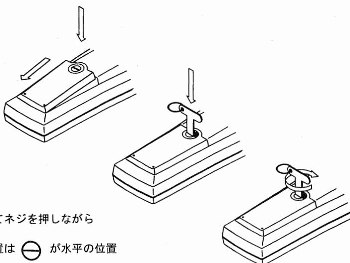
⑥専用ドライバーを用いてネジを押しながら
