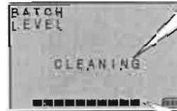
SET ボタンを押して、ピークホールド解除後切換スイッチを切り替えるとセンサクリーニングが始まります。
