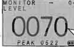
切換スイッチを Air 側へ切り替え表示が100以下に下がったことを確認します。
