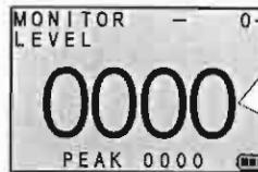
READY! 状態から SET ボタンを押し、ゼロベースをセットすると、0を表示します。切換スイッチを Odor 側へ切り替え、測定を開始します。レベル表示の場合 4 衔、臭気指数表示の場合 2 衔表示になります。
