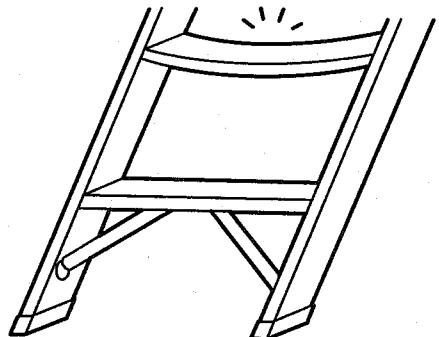
④各部の接合部に割れや著しい腐食がありませんか。また、取り付け部品の破損・脱落・変形・磨耗・著しい腐食がありませんか。ある場合は、絶対に使わないで、廃棄してください。
