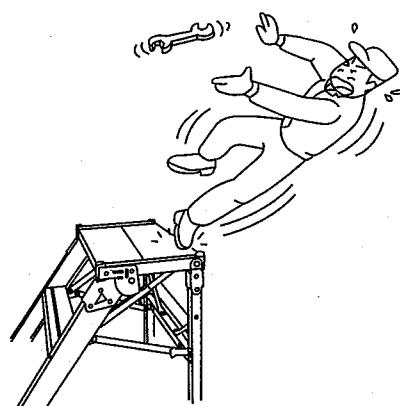
**△警告** 作業中に作業台を移動するときは、作業台から一旦降りて移動してください。
