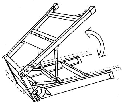
②開き止め連結棒を押し下げて開き止め金具が確実にロックするか点検してください。できないときは、絶対に使わないで、破棄してください。
