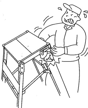
**△警告** 作業台を完全に開き、開き止め金具を確実にロックしてください。
