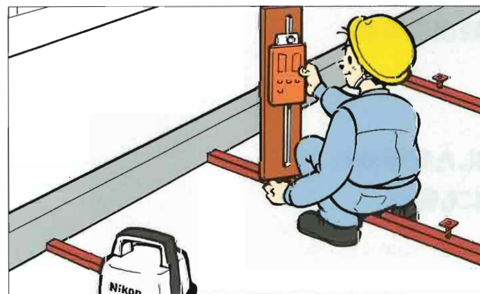
床フレームのレベル出し(墨出しアダプタ使用:別売り)
