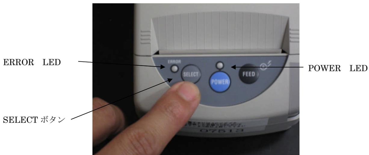
5. 充電が完了すると **POWER LED** が点灯し、印刷待機の状態に戻ります。
