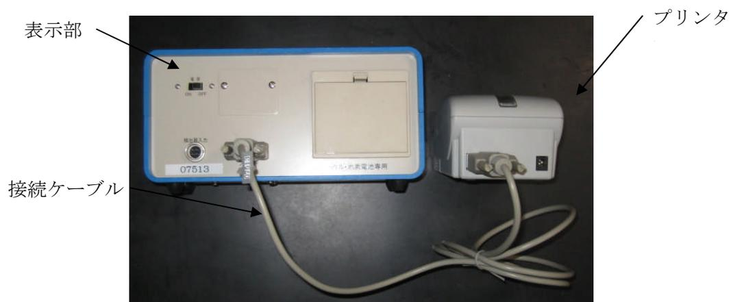
2. プリンターの電源スイッチを 2~3 秒押し続け On にし、表示部の印字ボタンをおします。
