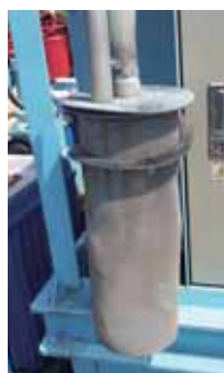
大型砂こしフィルタでポンプ 本体を保護(清掃も簡単です)
