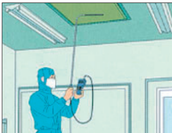
クリーンルーム内の風速測定
