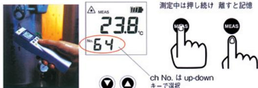
3443 管理ポイントに合わせてチャンネルNo（1～64）を選択します。MEASキーで測定し、MEASキーから離すと温度・日時が自動的に記憶されます。
