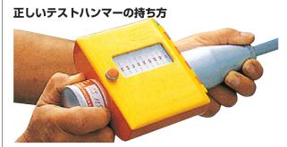
▲測定の際、ケース部を手で持たないで下さい。 破損の原因となります。
