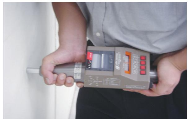
▲測定の際、ケース部を手で持たないで下さい。破損の原因となります。
