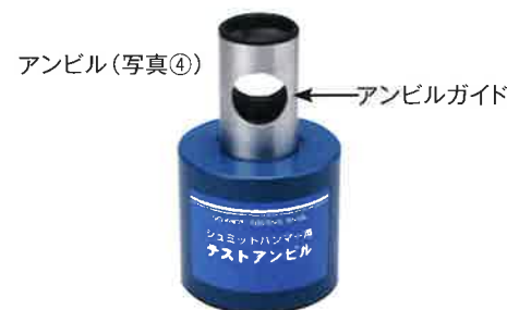
サイズ：高さ215mm×直径130mm 重量：13kg以上(JIS A1155による)
