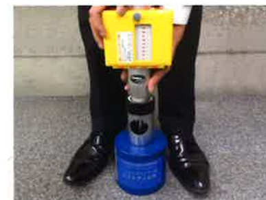
アンビルによる精度確認状況(写真⑤)
